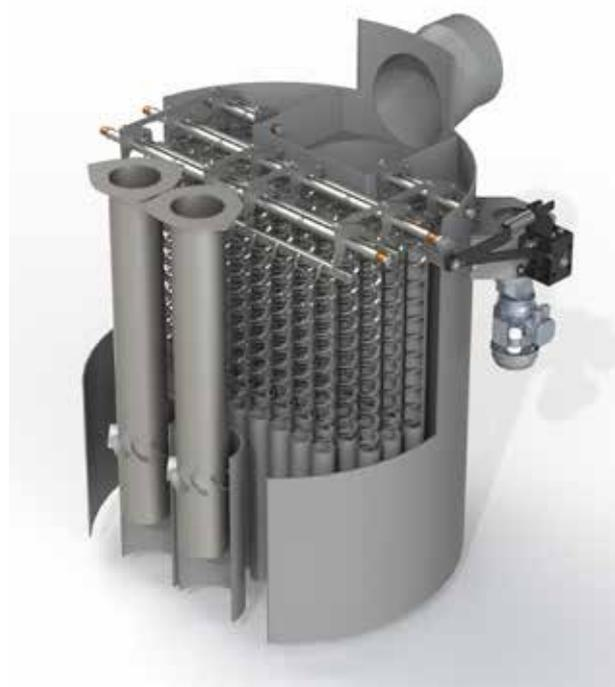
**Separado mecánicamente...** La cámara de combustión y el intercambiador de calor se construyen separados mecánicamente, y el estrés térmico lo absorbe la brida de unión entre ambos, de forma que no influye en el conjunto del cuerpo de la caldera. Además este diseño facilita el transporte, colocación y montaje de la caldera.
