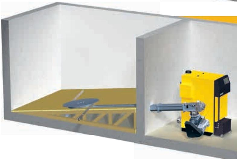
**¿Con o sin rampas de suelo?** Sin rampas de suelo la construcción del agitador de fondo es más económica. Así se asegura un funcionamiento silencioso. De todas formas una pequeña parte del depósito no se podrá vaciar automáticamente. Hay que rellenar esta parte en el primer llenado con astilla muy seca. Si decide instalar unas rampas de suelo, quedará menos astilla no utilizada en el depósito.
