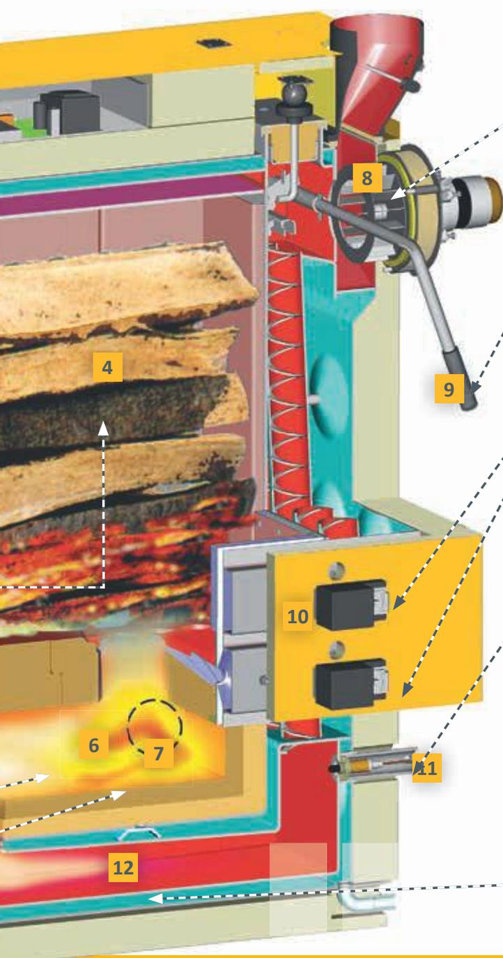
**8 Ventilador de humo:** Silencioso como un susurro, este ventilador mantiene una presión negativa en la caldera. Además controla la cantidad de aire y logra una seguridad en el cuarto de caldera.
