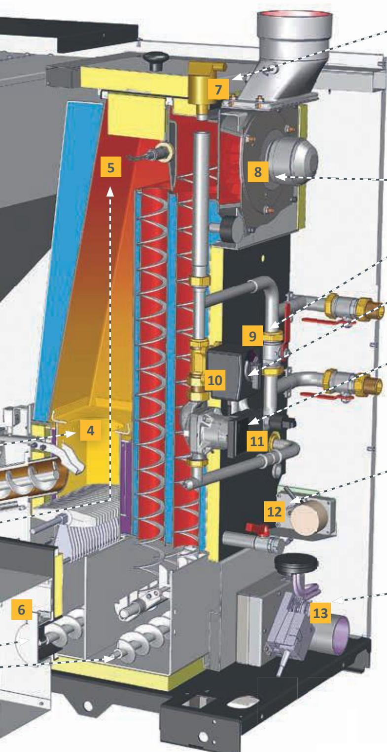
**7 Elementos de seguridad:** La caldera dispone de válvula de seguridad y sensor electrónico de presión para proteger contra presión excesiva. También tiene un purgador rápido integrado, para sacar el aire indeseado de los circuitos de calefacción. La caldera no necesita ninguna válvula de descarga térmica, ya que la cantidad de combustible dentro es tan pequeña que no hay riesgo de sobrecalentamiento.
