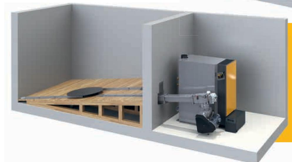
**¿Con o sin rampas de suelo?** Sin rampas de suelo la construcción del agitador de fondo es más económica. Así se asegura un funcionamiento silencioso. De todas formas una pequeña parte del depósito no se podrá vaciar automáticamente. Hay que rellenar esta parte en el primer llenado con astilla muy seca. Si decide instalar unas rampas de suelo, quedará menos astilla no utilizada en el depósito.
