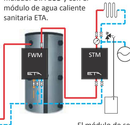
El módulo de separación de sistema ofrece seguridad cuando se tiene que separar el sistema de calefacción: por ejemplo para calentar establos, para sistemas de protección contra hielo o sistemas antiguos donde entra oxígeno.
