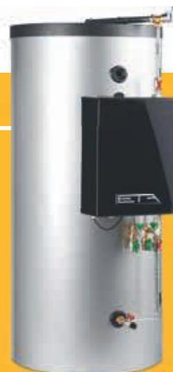
Las vainas para los sensores están situados para poder optimizar el funcionamiento del control. No es necesario instalar vainas, ya vienen integradas. De esta forma se pueden cambiar los sensores de sitio si es necesario sin tener que vaciar el agua.
